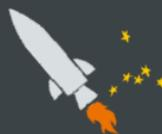
Los cohetes utilizan una reacción química durante el despegue. La combinación de combustible y oxígeno produce gases de combustión y de escape. Estos gases salen de la tobera del motor a alta velocidad y empujan el cohete hacia el cielo.
